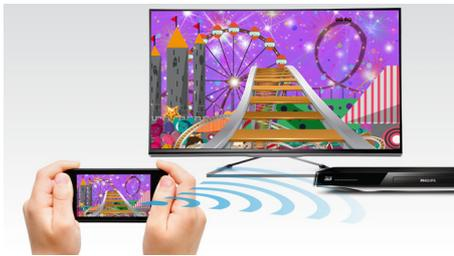
Miracast™ es un estándar inalámbrico de presentación en pantalla entre usuarios creado a través de conexiones Wi-Fi. La interfaz de usuario simplificada duplica la pantalla del dispositivo portátil en una pantalla más grande mediante un dispositivo con Miracast™, sin límites de códecs incorporados para decodificación.
