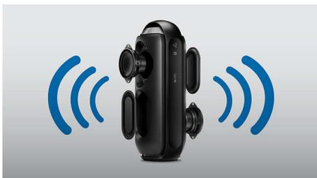
Los parlantes con controlador de neodimio de 1,5" doble proporcionan un sonido natural, nítido y equilibrado, mientras los radiadores pasivos opuestos duales amplían y refuerzan los graves. Los controladores del parlante frontal y trasero de rango completo crean un sonido que puede llegar a 360 grados y ofrecen la libertad de disfrutar de la misma calidad de sonido independientemente de su orientación.
