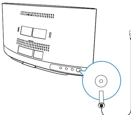
Connectez l'antenne FM au produit.
