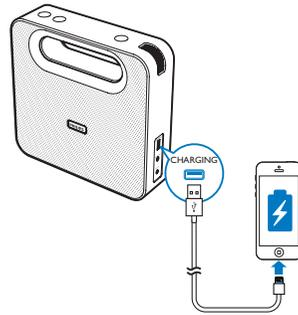
En mode d'alimentation secteur, connectez-la à votre appareil mobile à l'aide d'un câble USB (non fourni).
