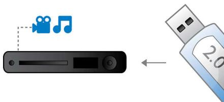
Evrensel Seri Veri Yolu veya USB, PC'leri çevre birimlerine ve elektronik cihazlara kolayca bağlamak için kullanılan bir protokol standardıdır. Yüksek Hızlı USB cihazların veri aktarım hızı, orijinal USB'lerin 12 Mb/s üzerine çıkararak 480 Mb/s'ye kadar ulaşır. Yüksek Hızlı USB 2.0 Bağlantısı ile yapmanız gereken tek şey, USB cihazınızı takmak, film, müzik veya fotoğrafı seçmek ve hemen oynamak.
