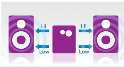
El amplificador doble optimiza el rendimiento del sonido: reduce la intermodulación entre el woofer y el tweeter porque cada transductor está controlado por su propio amplificador. Como resultado, los sonidos graves son más profundos y potentes. Además, generan interferencias mínimas con las frecuencias más altas para ofrecerte un audio puro y detallado. A esto se le suma el diseño de filtro de cruce activo que logra un mejor control en la fase y la frecuencia de respuesta de cada transductor
