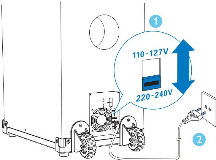
Antes de conectar à alimentação, verifique se a voltagem da fonte de alimentação corresponde à voltagem definida no seletor de voltagem na parte traseira do aparelho.
