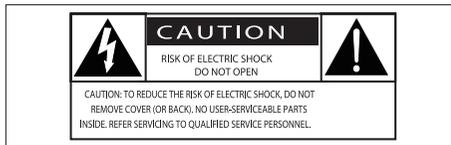
Este 'raio' indica a presença de material sem isolamento no interior do aparelho que pode causar choque elétrico. Para a segurança de todas as pessoas em sua casa, não remova a tampa do produto.
