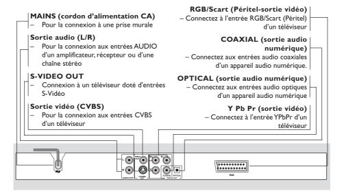
Attention : Ne pas toucher les broches des connecteurs situés sur le panneau arrière. Une décharge électrostatique peut irrémédiablement endommager l'appareil.
