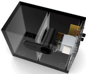
Con su diseño de una caja dentro de otra, este subwoofer con paso de banda dispone de dos cámaras de volumen para crear más capacidad de aire y ofrecer un sonido grave general de mejor calidad, con un mejor equilibrio y menos distorsión. La energía de audio del controlador central se concentra de forma más eficaz en el rango de frecuencia de salida deseado, produciendo una imagen sonora general más definida y una reproducción más precisa.
