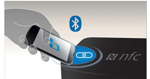
Koppeln Sie Bluetooth-Geräte mit der One-Touch-NFC-Technologie (Near Field Communications) durch eine einfache Berührung. Berühren Sie das NFC-fähige Smartphone oder Tablet im NFC-Bereich eines Lautsprechers, um den Lautsprecher einzuschalten, die Bluetooth-Kopplung zu starten und mit der Musikübertragung zu beginnen.
