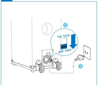
Antes de conectar la alimentación, cambie el selector de voltaje de alimentación que se encuentra en la parte posterior del panel para seleccionar el voltaje que coincida con el suministro local de energía.
