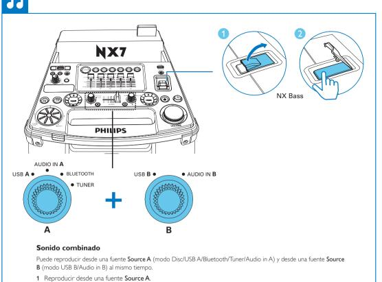
3 Utilice CROSS FADER ASSIGN para ajustar el balance del canal izquierdo/derecho durante la reproducción.
