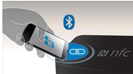
Koppeln Sie Bluetooth-Geräte mit der One-Touch NFC-Technologie (Near Field Communications) durch eine einfache Berührung. Berühren Sie das NFC-fähige Smartphone oder Tablet im NFC-Bereich eines Lautsprechers, um diesen einzuschalten,
