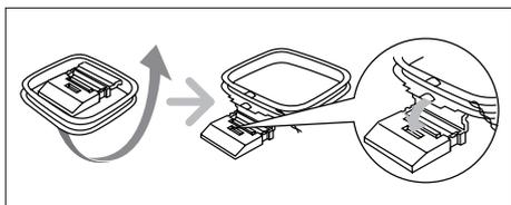
2 Conectar a antena de quadro **AM** à entrada **AM** na parte posterior da unidade principal.
