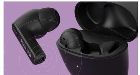
Fai molte chiamate? Puoi raddoppiare il tempo di conversazione utilizzando un auricolare mentre l'altro si ricarica. Il microfono viene assegnato automaticamente all'auricolare in uso e passi da un auricolare all'altro quando la batteria dell'auricolare corrente si scarica.
