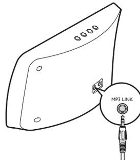
3 オーディオケーブルのもう一方を、接続する外部機器の出力端子に差し込みます。
