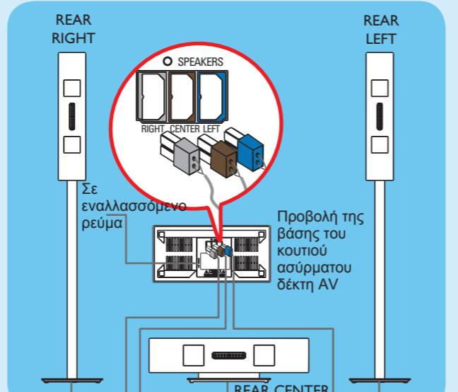
Σημείωση Για βέλτιστη ασύρματη απόδοση, βεβαιωθείτε ότι το κουτί ασύρματου δέκτη AV δεν τοποθετείται σε περίκλειστο χώρο.
