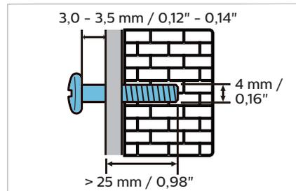
Pogledajte ilustraciju u brzom vodiču kako postaviti zvučnik SoundBar na zid.
