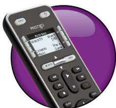
O comando dispõe de um ecrã LCD de 3,8 cm (96x64 pixéis). Os botões utilizados com menor frequência estão disponíveis através do visor, para que possa adicionar os seus próprios botões ou remover os botões de que não necessita.
