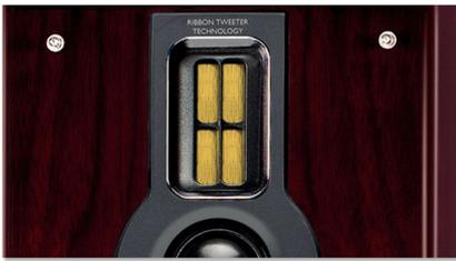
磁石鋁帶式 (Neodymium) 高音喇叭是一種單極單體可以呈現清脆生動的音質，常用於高級音響系統，可重生高傳真音質。傳統錐形或球頂形單體應用了指向性線圈移動原則，單極磁石鋁帶式高音喇叭則達 180 度廣角振幅射出高頻音。如此高頻音域更寬廣，也擴展最佳聆聽區域，即便是迷你型音響系統也能有寬廣、清晰、自然的音質。
