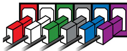
Les connecteurs de couleur facilitent la connexion des enceintes et des caissons de basses à l'unité centrale du système Home Cinéma. Branchez simplement les câbles aux connecteurs de même couleur à l'arrière de l'unité.
