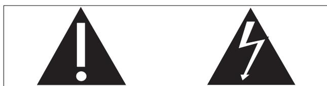
Ce symbole éclair signifie que les composants non-isolés de votre appareil peuvent provoquer une décharge électrique. Pour la sécurité de votre entourage, ne retirez pas le couvercle du produit.
