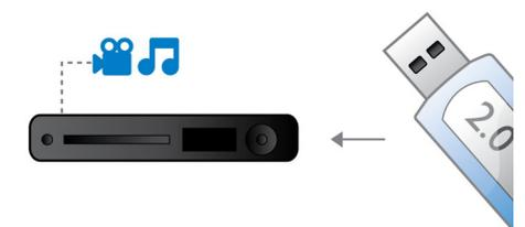
USB 接口是连接电脑、外围设备和消费电子设备所广泛采用的一种协议标准。高速 USB 设备的数据传输速度高达 480 Mbps - 远高于原始 USB 的速度 12 Mbps。使用高速 USB 2.0 连接，只需插入 USB 设备、选择影片、音乐或照片即可立刻播放。
