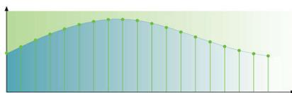
El muestreo a 192 KHz permite tener una representación precisa de las curvas de sonido originales. En combinación con una resolución de 24 bits, se captura más información de la forma de onda del sonido analógico original
