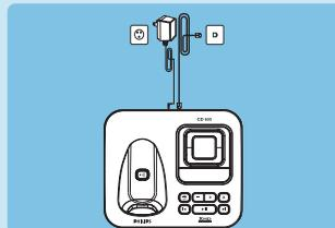
2. Подключите телефонный шнур и шнур питания к соответствующим разъемам на задней панели базовой станции.
