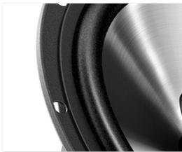
Un tissu extrêmement sensible connecte le diaphragme de haut-parleur de graves au cadre du haut-parleur pour former un système de suspension. Lorsqu'un signal sonore atteint le cône dans le haut-parleur de graves, le tissu remplace le cône dans sa position pour recevoir un autre signal sonore. Ce faisant, le haut-
