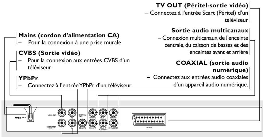
**Attention : Ne pas toucher les broches des connecteurs situés sur le panneau arrière. Une décharge électrostatique peut irrémédiablement endommager l'appareil.**
