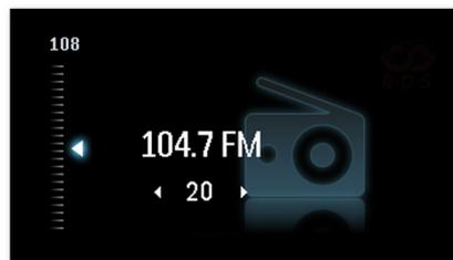
Basta sintonizar a estação que pretende programar, premir e manter o botão de programação premido para memorizar a frequência. Através das estações de rádio programadas que podem ser guardadas, pode aceder rapidamente à sua estação de rádio preferida sem necessitar de sintonizar manualmente as frequências.
