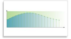
El muestreo a 192 KHz permite obtener una representación precisa de las curvas de sonido originales. En combinación con una resolución de 24 bits, se captura más información de la forma de onda del sonido analógico original y se consigue una reproducción de audio de mayor calidad.
