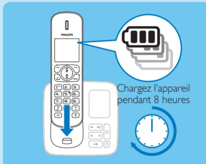
Placez le combiné sur la base pour le mettre en charge. La base émet un bip lorsque vous placez le combiné sur la base.
