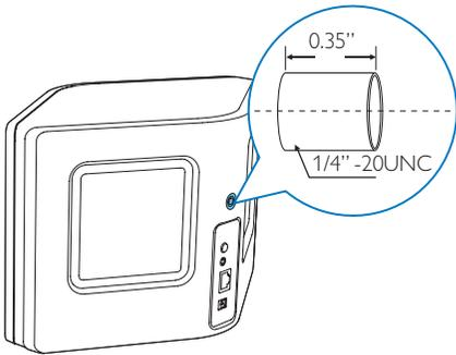
A través de este orificio, puede montar fácilmente el dispositivo en la pared mediante un soporte de montaje adecuado. El soporte de montaje no se incluye, debe adquirirlo. Siga las instrucciones que incluye el soporte de montaje en pared que ha adquirido.
