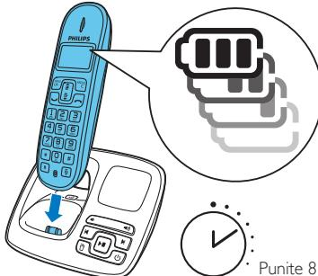
Stavite slušalicu na baznu stanicu da biste napunili njenu bateriju. Kada slušalicu ispravno stavite na baznu stanicu, čuće se zvučni signal. ↪ Baterije u slušalici će početi da se pune.
