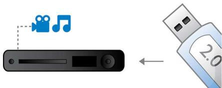
Универсалната серийна шина или USB е стандарт за протокол за свързване на компютри, периферия и потребителска електроника. Устройствата с високоскоростен USB имат скорост на пренос на данни до 480 Mbps - срещу скромните 12 Mbps на тези с първоначалния USB интерфейс. С връзката с високоскоростен USB 2.0 всичко, което трябва да направите, е да включите USB устройството, да изберете филма, музиката или снимките и да ги гледате и слушате.
