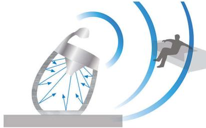
La face arrière soigneusement incurvée de ce haut-parleur avec station d'accueil Philips crée une structure acoustique permettant de reproduire le son avec une efficacité surprenante. Cette conception renforce la rigidité du boîtier du haut-parleur réduisant ainsi considérablement la résonance interne afin d'éliminer les vibrations et les distorsions sonores. Vous profitez ainsi d'un son d'une qualité incomparable grâce à un haut-parleur par ailleurs agréable à regarder.
