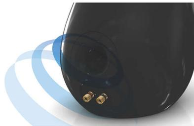
La charge acoustique Bass Reflex utilise un caisson de basses réglé sur le volume acoustique du haut-parleur, afin de reproduire des basses profondes à partir de boîtiers de petite taille. Le caisson de basses profilé facilite la circulation de l'air et permet d'obtenir des basses profondes et percutantes, même à des volumes élevés tout en atténuant les turbulences d'air pouvant entraîner des distorsions.
