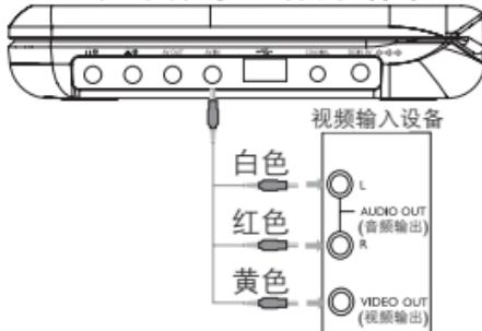
视频扩音器、数字视频录像机和数码相机等视频输入设备上应具有 RCA 输出连接。如果您的设备没有 RCA 输出，请咨询经销商。
