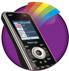
Una pantalla LCD de 5,6 cm (176 x 220 píxeles) a todo color que ofrece calidad de alta resolución y lectura fácil. La pantalla sensible al tacto muestra sólo las teclas que necesitas y permite navegar rápidamente por la pantalla del mando a distancia.
