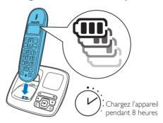
Placez le combiné sur la base pour le mettre en charge. La base émet un bip lorsque vous placez le combiné sur la base.
