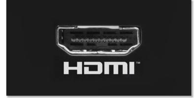
HDMI 是一个可以承载数字高清视频以及数字多声道音频的直接数字连接方式。由于无需转换为模拟信号，它可以产生优异的画面和声音效果，完全不受噪音干扰。HDMI 完全向后兼容 DVI。
