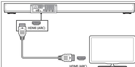
1 Χρησιμοποιώντας καλώδιο HDMI υψηλής ταχύτητας, συνδέστε την υποδοχή **HDMI OUT (ARC) -TO TV** στη Μπάρα όχου στην υποδοχή **HDMI ARC** της τηλεόρασης.
