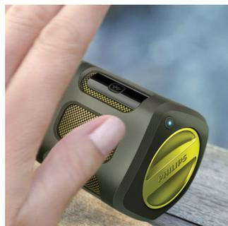
SHOQBOX è dotato di un sensore di movimento. Fai passare semplicemente la mano sul sensore da sinistra a destra o da destra a sinistra per passare al brano successivo o all'ultimo. Appoggia la mano sul sensore per un secondo per fermare la musica e ripeti il gesto per farla ripartire. I semplici comandi controllati gestualmente ti consentono di controllare la musica nel modo più semplice.
