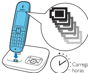
Coloque o telefone na estação de base para o carregar. Quando o telefone é correctamente colocado na estação de base, ouve um ruído de encaixe.
