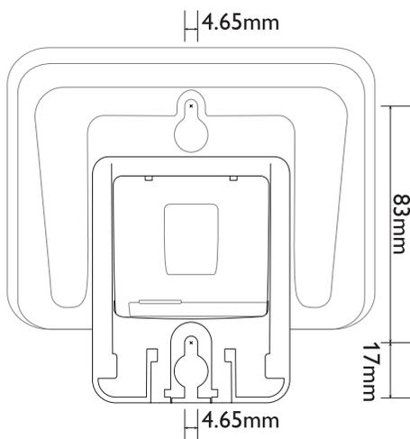
**5** Alignez les orifices de montage de l'arrière de la station de base avec les vis dans le mur.
