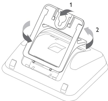
**3** Réinsérez le socle à l'arrière de la station de base.
