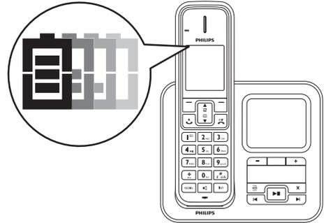
L'icône de batteries indique le niveau actuel de charge des batteries.
