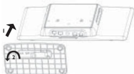
**Nota:** quando si installa il televisore su una parete, (fare riferimento alla sezione Montaggio a parete), sganciare il supporto. Per sganciare il supporto, sollevare il perno e ruotare in senso orario.
