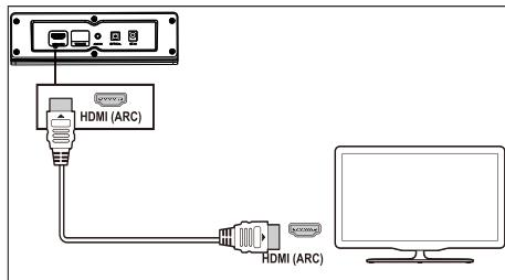
**1** HDMI kabel velike brzine spojite na priključak **HDMI (ARC)** soundbar zvučnika na **HDMI ARC** priključak na TV-u.
