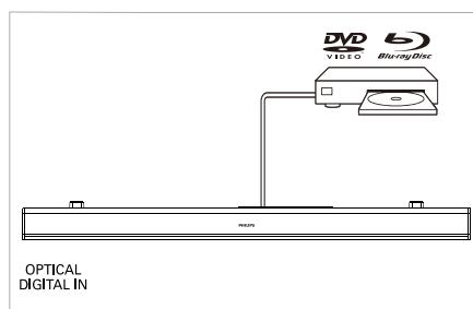
Koristeći optički kabel spojite **OPTICAL** priključak na svojem soundbar zvučniku na **OPTICAL OUT** priključak na TV-u ili drugom uređaju.
