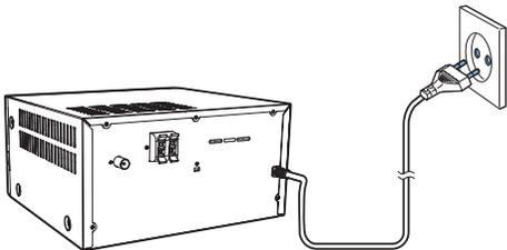
Collegare il cavo di alimentazione alla presa a muro.
