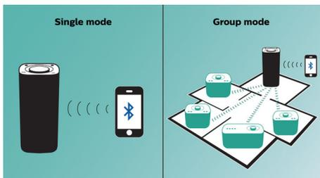
Беспроводная технология izzylink™ использует стандарт IEEE 802.11n для объединения нескольких АС и создания беспроводной сети, к которой можно подключить до пяти систем без использования роутера, пароля Wi-Fi или мобильного приложения на смартфоне. Вы сможете наслаждаться музыкой одновременно в разных комнатах, добавив АС izzy в сеть. Простым нажатием кнопки выбирайте для каждой АС режим индивидуального воспроизведения или режим группы для прослушивания музыки сразу в нескольких комнатах.
