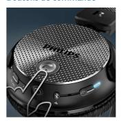
Les boutons de commande situés au niveau de la coque droite vous permettent de contrôler la musique et les appels téléphoniques d'une simple pression.
