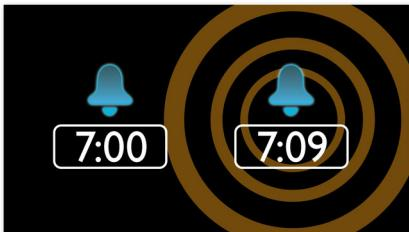
Da se ne biste uspavali, Philips radio sa budilnikom poseduje funkciju odlaganja. Ako se alarm oglaši, a vi želite da nastavite da spavate malo duže, samo pritisnite jedanput dugme Ponavljanje alarma i nastavite da spavate. Devet minuta kasnije alarm će se ponovo oglasiti. Možete da nastavite da pritiskate dugme Ponavljanje alarma na svakih devet minuta dok potpuno ne isključite alarm.
