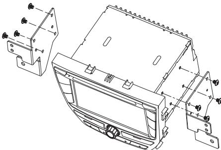
**4** 将装置滑入仪表板中, 并用四个螺钉将其固定在汽车上。
