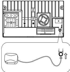
**2** 将 GPS 天线的另一端固定到汽车的金属表面。
