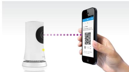
L'application In.Sight+ simplifie la configuration. Elle génère un QR code pour les paramètres Wi-Fi de votre maison. Grâce au QR code, le système de surveillance s'appare automatiquement, facilement et instantanément avec votre réseau Wi-Fi.
