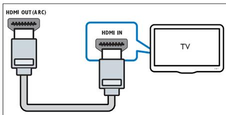
1 С помощью высокоскоростного кабеля HDMI подключите разъем **HDMI OUT (ARC)** домашнего кинотеатра к разъему **HDMI** телевизора.
