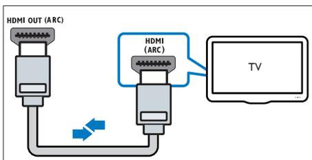
1 С помощью высокоскоростного кабеля HDMI подключите разъем **HDMI OUT (ARC)** домашнего кинотеатра к разъему **HDMI ARC** телевизора.
