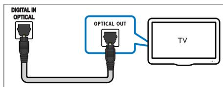
1 С помощью оптического кабеля подключите разъем **OPTICAL** домашнего кинотеатра к разъему **OPTICAL OUT** телевизора или другого устройства.
